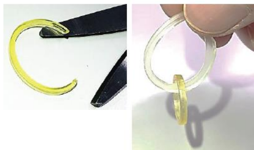
3Dプリンターで輪状の造形物を作製し はさみで切断、再接触させ輪同士を繋げた様
