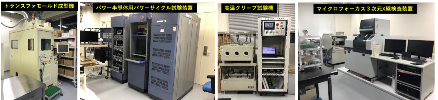
図 2. 材料性評価、実装、信頼性評価と劣化診断を行う代表的な装置
