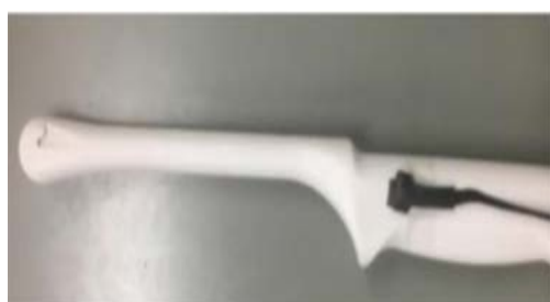
加速度センサを付けた超音波プローブ 卵胞ファントム断面画像 三次元復元した卵胞ファントム
