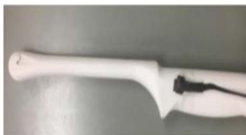
加速度センサを付けた超音波プローブ
