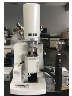
図2 熱機械分析装置(TMA)
